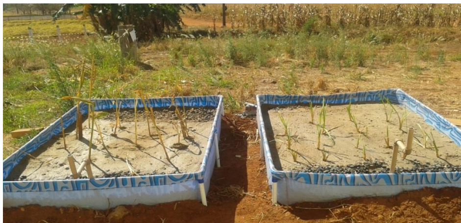
Figura 5. Estação experimental de tratamento de efluente com as mudas transplantadas.
