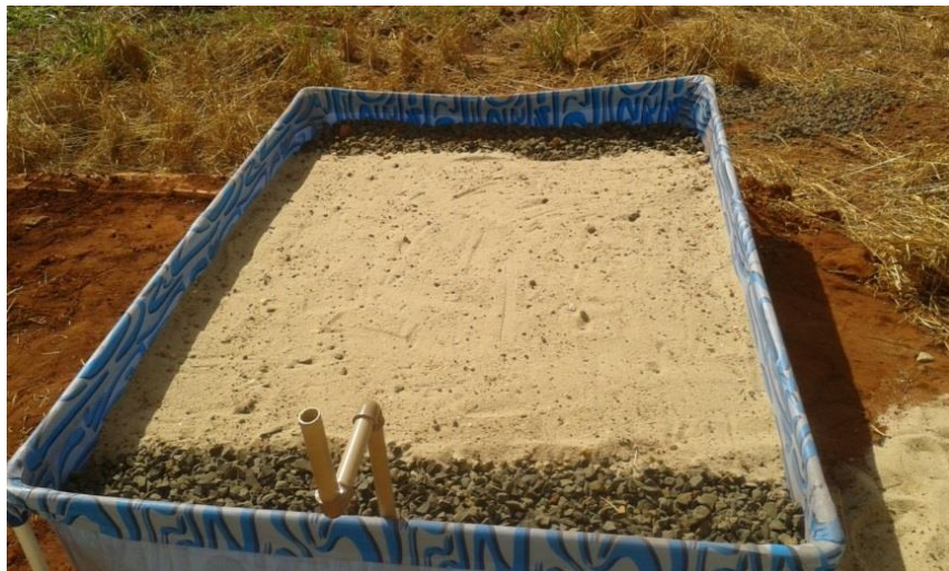
Figura 3. Imagem do leito para o plantio das espécies utilizadas na estação experimental de tratamento por zona de raízes.
