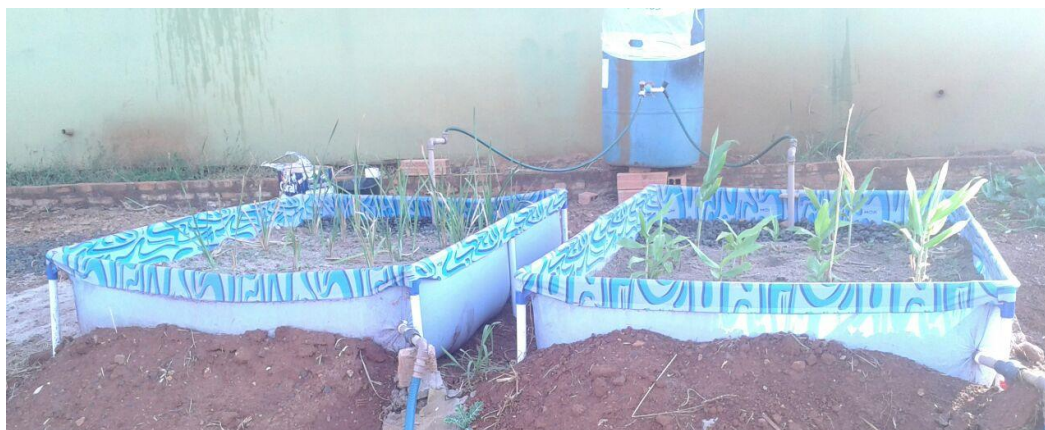
Figura 6. Estação experimental de tratamento de efluente em funcionamento.
